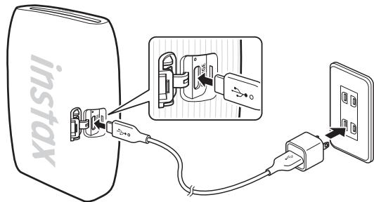
Приєднайте принтер за допомогою кабелю USB Type-C з комплекту постачання до адаптера змінного струму USB (з комплекту постачання смартфона), а потім підключіть адаптер змінного струму USB до внутрішньої мережі електропостачання.
